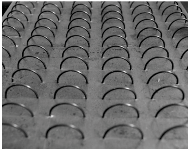
Abbildung 5.6: Wärmeübertragerstruktur in Form von Bögen der Grundgeometrie aus Stahldrähten mit einem Durchmesser von 1 mm auf eine Stahlplatte gesteckt
