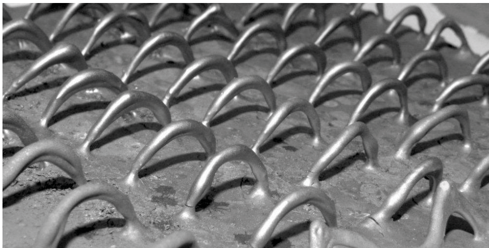
Abbildung 5.13: Prototyp-Wärmeübertragerstruktur aus Silizium infiltriertem Siliziumkarbid
