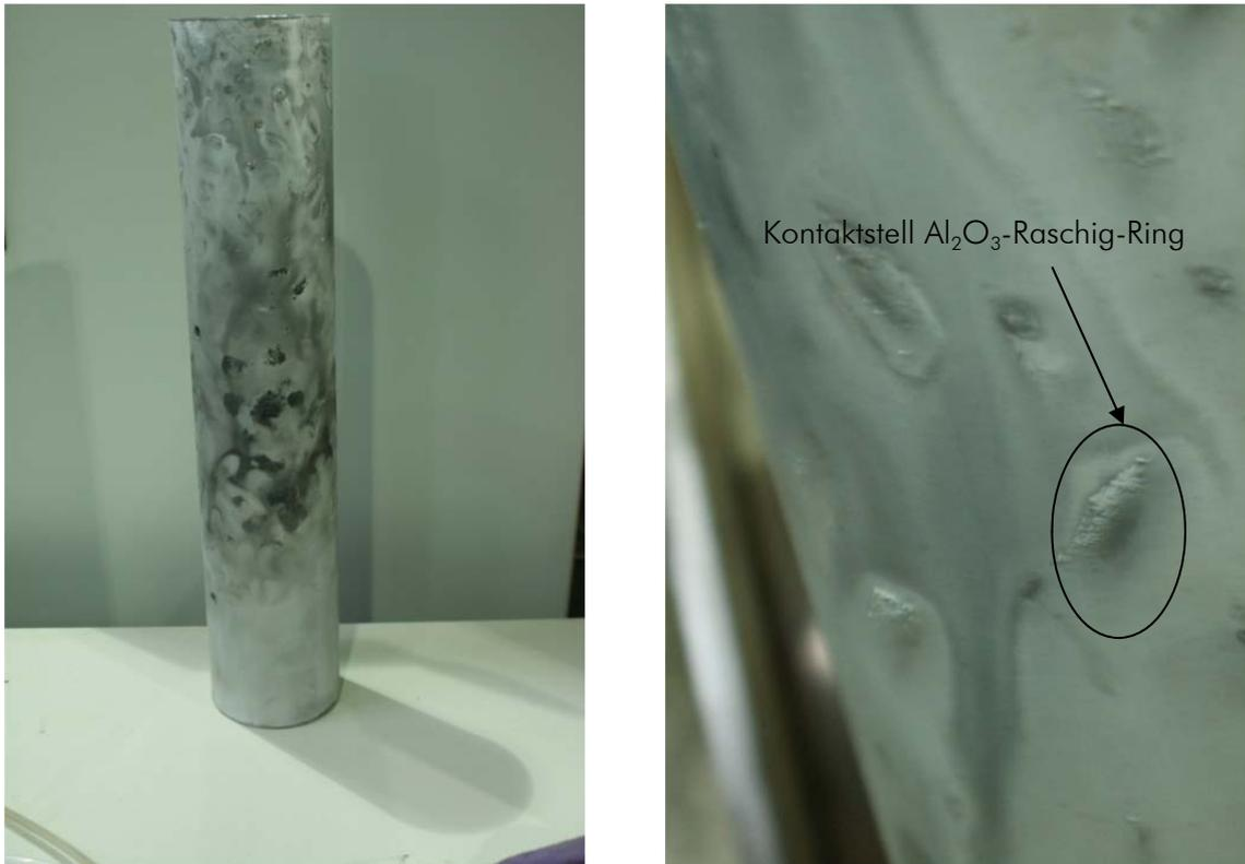
**Abbildung 58:** SSiC-Rohr nach Beendigung der Versuchsreihen
