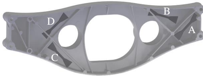
Abbildung 4-3: Probenentnahmepositionen an der Getriebequerbrücke
