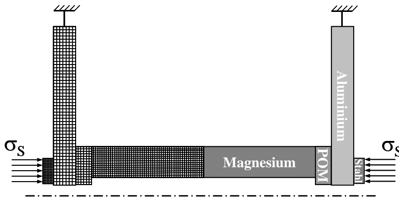
Abbildung 4-63: Netzdarstellung und Materialverteilung des Berechnungsmodells
