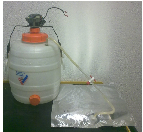
Abb. 15: Aufbau eines Reaktors für Batch-Versuche vgl. [9]
