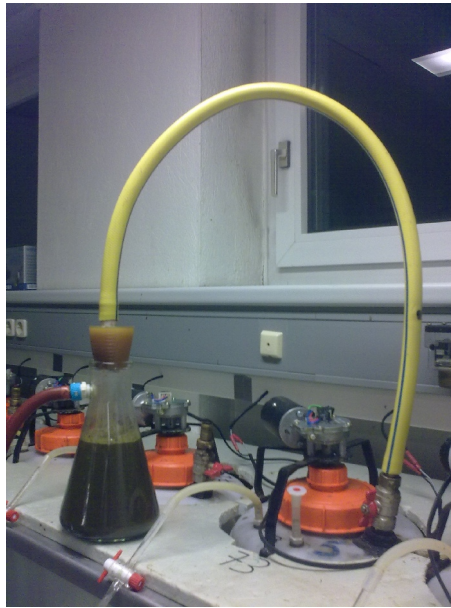
Abb. 19: Vorrichtung zur Entnahme des Gärrestes vgl. [9]
