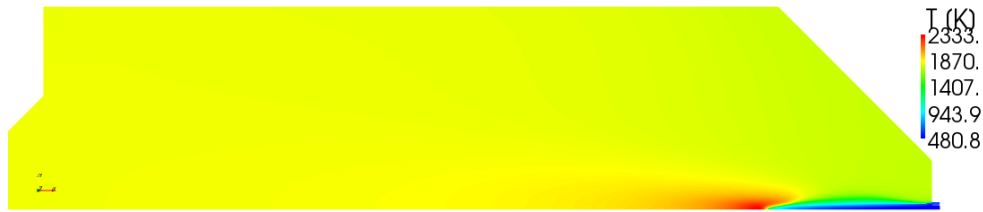
Abbildung 4.8: Die Berechnung mit Fluent-Standardereinstellungen auf den feineren Gittern führte bei zu großen Unterrelaxationsfaktoren zu einem starken Flammenabhub.
