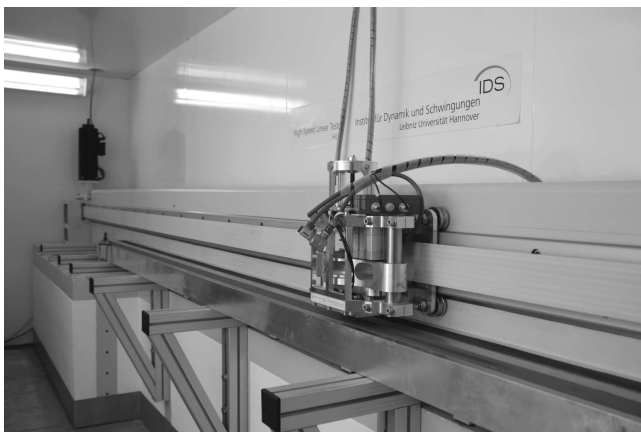
Bild 2.14: Links: Gesamtansicht des Hochgeschwindigkeits-Linearprüfstands in der Kältekammer; rechts: Detailansicht der Messkapsel
