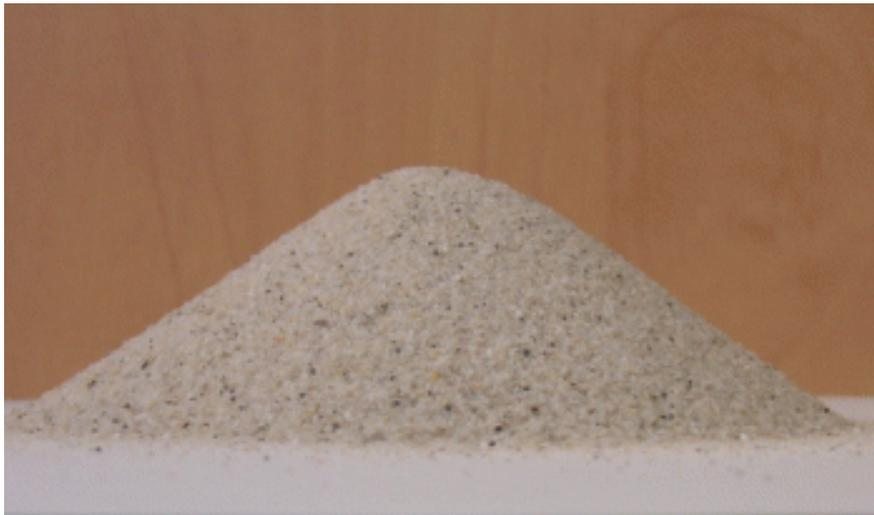
**Abbildung 6-1.:** Sand Marke H32 mit dem Schüttwinkel von  $\varphi = 35^\circ$
