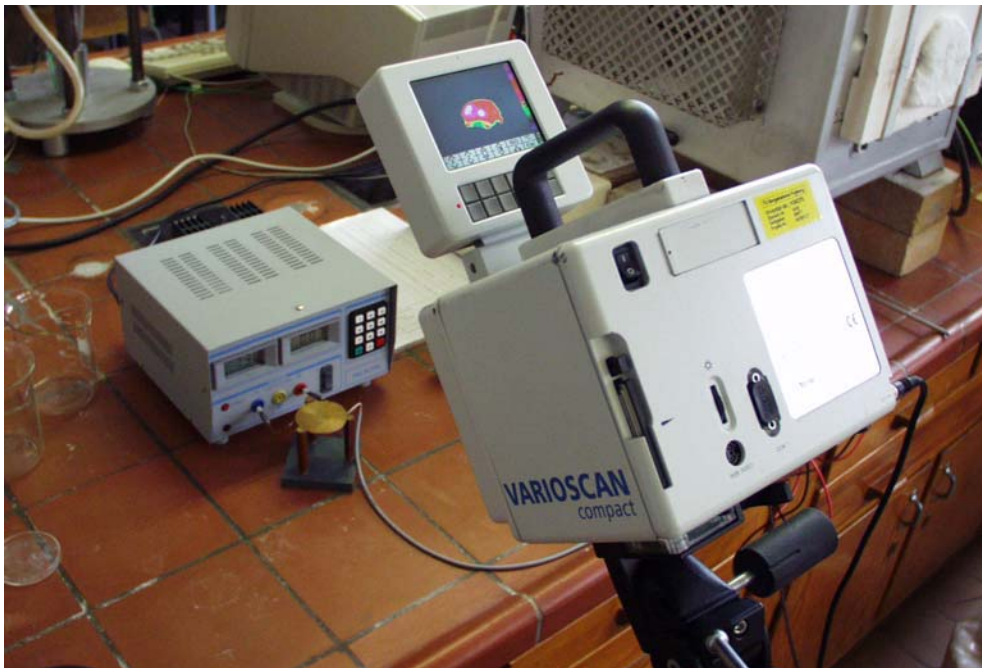
Abb. 9: Aufbau zur Messung der Temperaturverteilung
