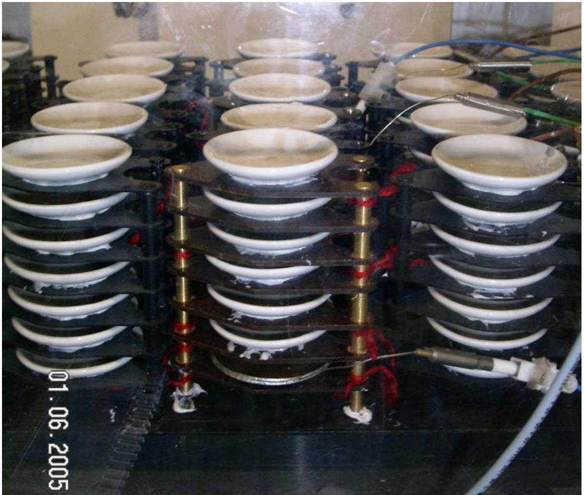
Abb. 47: Strömungsfäden aus Wolle zur Validierung der Strömungsrichtungen
