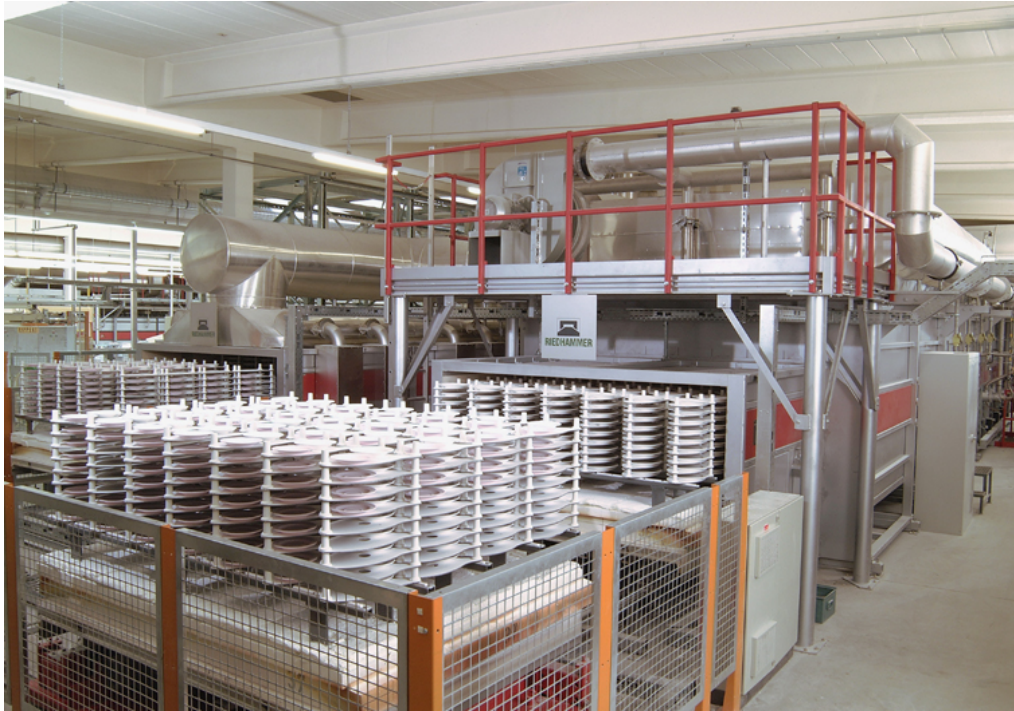
Abb. 3: Schnellbrandofen zum Glasurbrand von Porzellan (Foto: Riedhammer)
