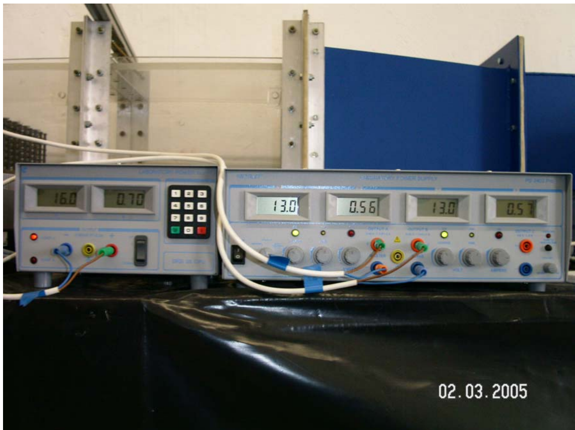
Abb. 8: Spannungsversorgung für die Modellteller
