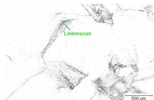
Abbildung 16-4 Zugehörige Versetzungsverteilung zum links abgebildeten \Gamma -Topogramm. Jeder schwarze Punkt entspricht mindestens einer Versetzung.
