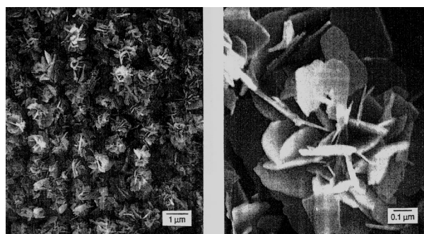
Abb. 4.2.2.5. Die SEM-Aufnahmen von \text{SnS} , dargestellt durch Pyrolyse von (\text{Ph}_2\text{SnS})_3 [27], zeigen rosettenartige Cluster aus \text{SnS} -Plättchen von ca. 1\text{ }\mu\text{m} Größe mit einer Dicke der Plättchen von 250 - 500\text{ \AA} .
