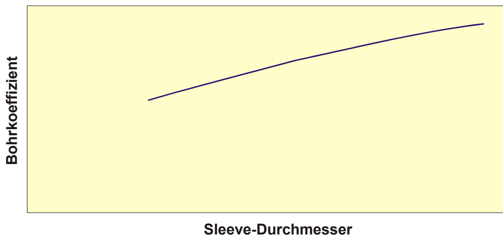
Abbildung 23: Einfluss des Innendurchmessers des Thruster Sleeves auf den Bohrkoeffizienten
