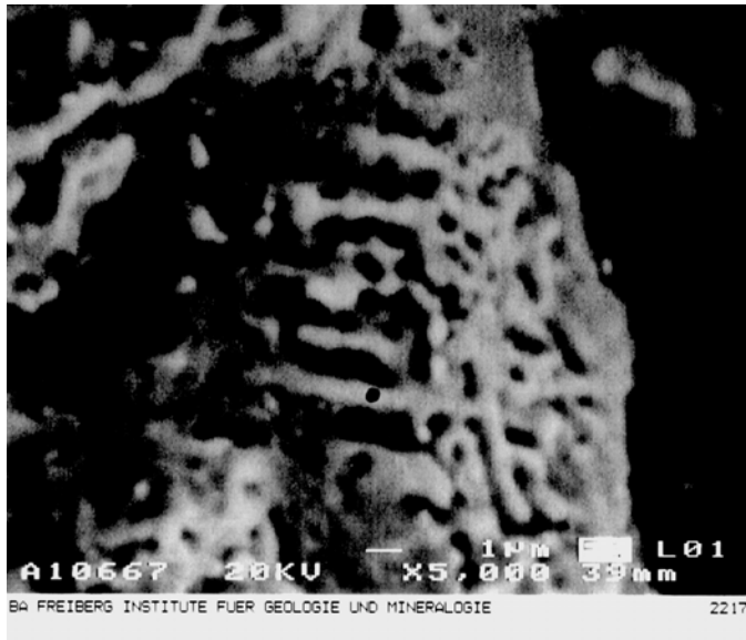
Bild 23: REM-Aufnahme eines aus Nickelchlorid und Silicium erhaltenen Produktes aus dem horizontalen Rohrreaktor
