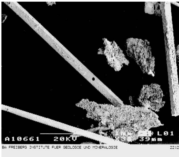
Bild 7: Rasterelektronenmikroskopische Aufnahme der erhaltenen Kristalle aus dem Silicidbildungversuch mit Nickel und Silicium in einer Zinnschmelze
