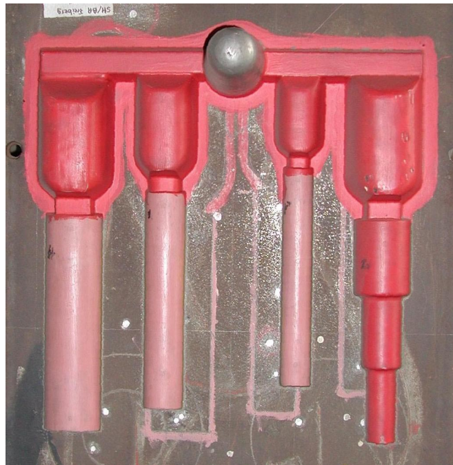
Bild 49: Modellplatte zur Herstellung von Rundstäben verschiedener Wanddicken (Ø25; 35; 50 mm)
