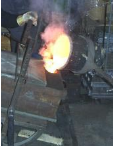
Bild 17: Kippguss bei Gießbeginn
