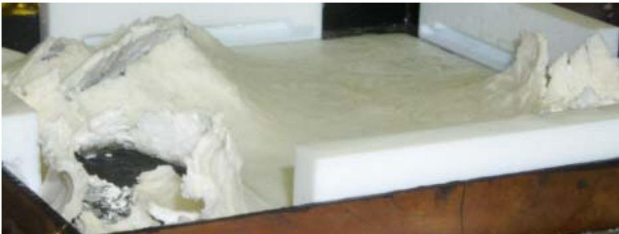
Abb. 23: DC-Platte nach erfolgter Kristallisation der Salzhydratschmelze
