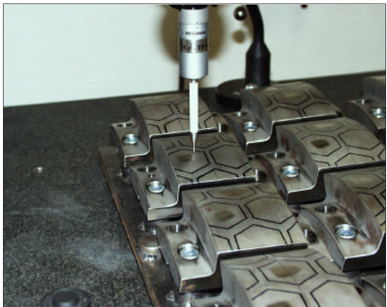
Abb.77: Meßtaster beim Ausmessen einer Segmentfliese
