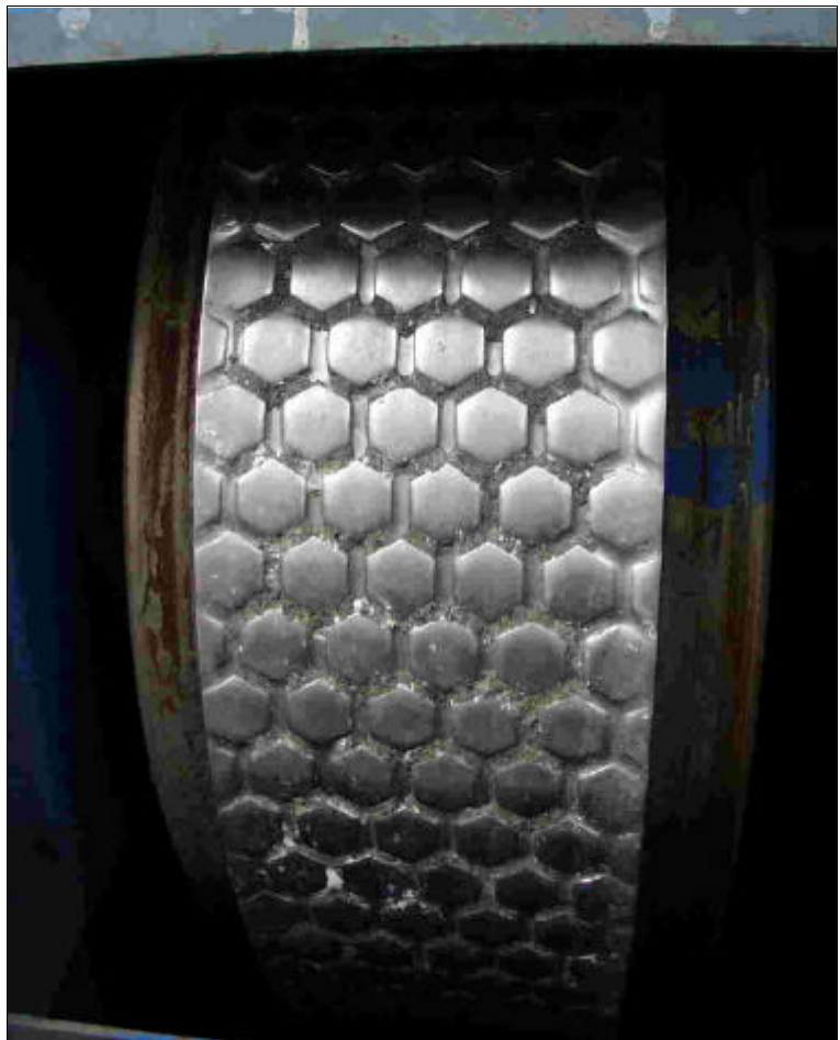
Abb.74: Verschleißoberfläche aus Hexadur®-WT1
