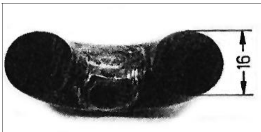
Abb.3: Verschleiß im Gelenk eines Rundstahlkettengliedes
