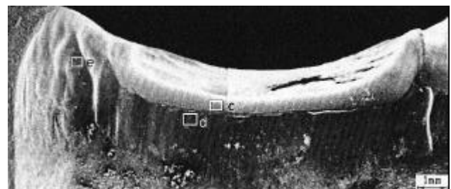
Abb.4: Nahaufnahme der verschlissenen Oberfläche des Kettengliedes
