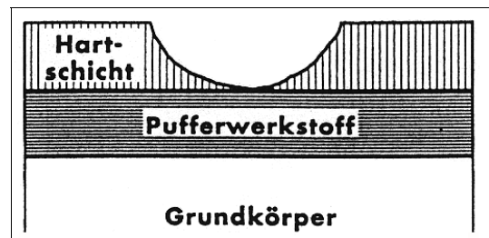
Abb.33: Peeling, Ablösen der Hartschicht
