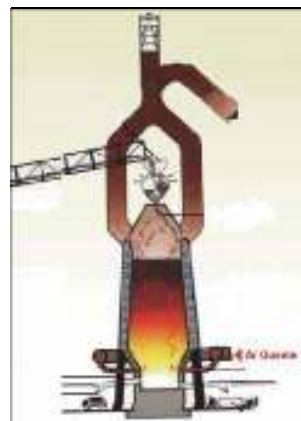
FIGURA 2 – Entrada de ar quente em alto forno
