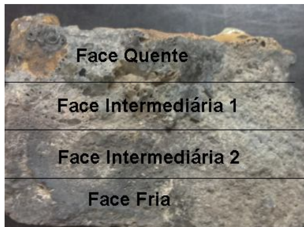
Figura 9 – Amostra Escura enviada para teste: Face Fria (FF/ 0 a 20mm), Face Intermediária 2 (FI-2 /20 a 40mm), Face Intermediária 1 (FI-1/ 40 a 60mm) e Face Quente (FQ/ 60 a 75mm)
