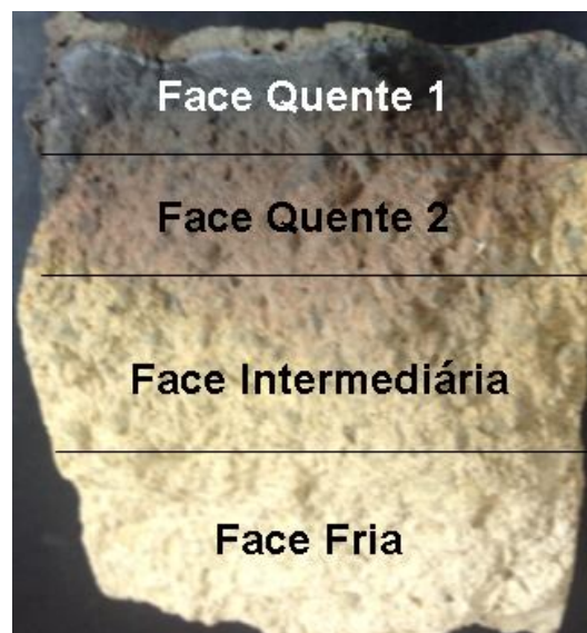
Figura 10– Amostra Escura enviada para teste: Face Fria (FF / 0 a 30 mm), Face Intermediária (FI/ 30 a 60 mm), Face Quente 2 (FQ-2/ 60 a 80 mm) e Face Quente 1 (FQ-1/ 80 a 95 mm).
