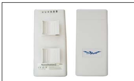
FIGURA 3. Exemplo de uma antena painel.
