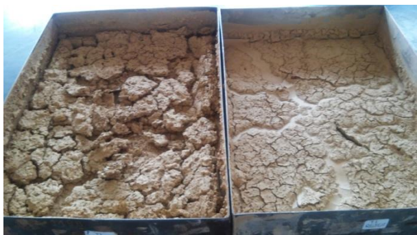
Figura 13 - Aspecto do material flotado e do não flotado, respectivamente, após a secagem Fonte: Próprio autor.
