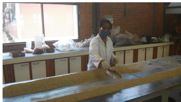
Figura 6 - Homogeneização em pilha Fonte: Próprio autor.
