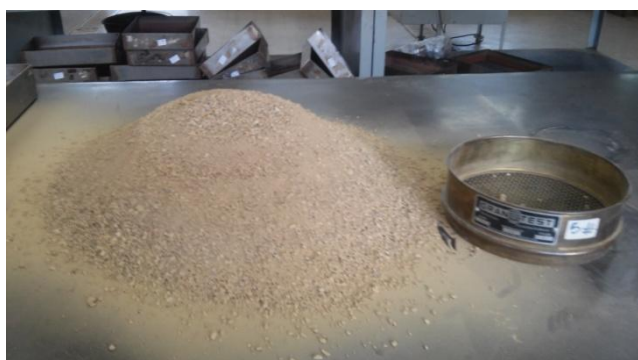
Figura 4 - Peneiramento em malha de 5 mesh Fonte: Próprio autor.
