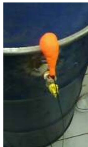
Figura 12 – O balão sendo enchendo com o biogás produzido do lixo orgânico
