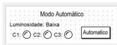
Figura 6 – Interface do Circuito Modo Automático
