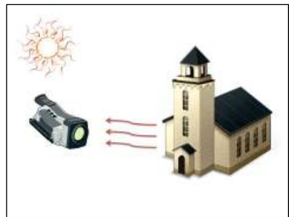
Figura 1 – Esquema de termografia passiva.
