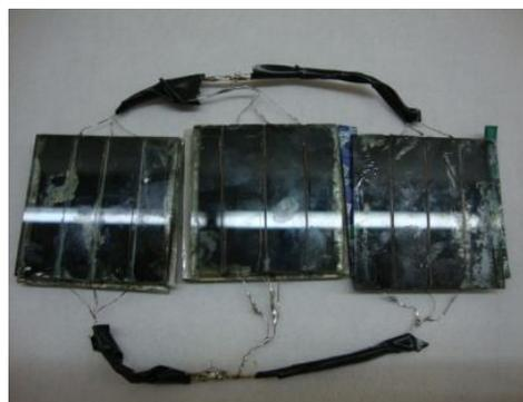
Figura 9: Célula fotovoltaica orgânica ligada em paralelo.
