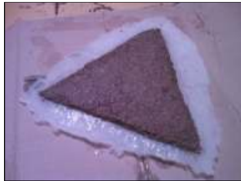
Figura 4 – Molde de azulejo com o material para secagem;
