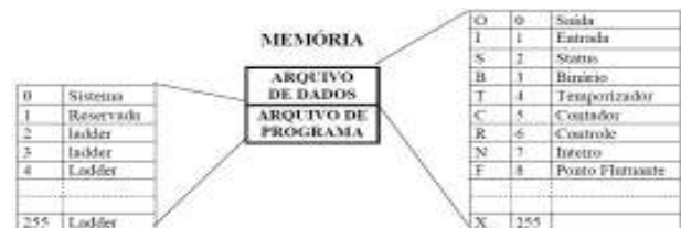
Figura 2 – Sistema básico de estrutura/Controle Fonte - PLÍNIO, 2008.
