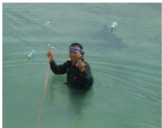
Hình 8. Bố trí lượng nổ dưới nước (trước và cách tấm mô hình bê tông 1,5m)
