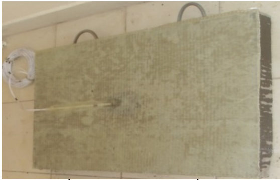
Hình 4. Tấm bê tông mô hình gắn lớp vật liệu giảm chấn dày 0,6 - 0,8 cm
