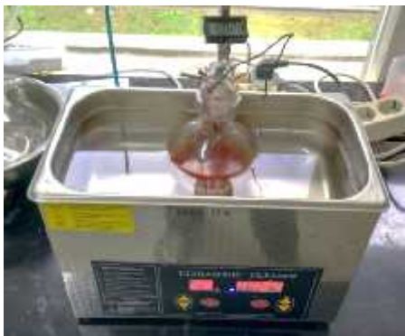
Gambar 1. Rangkaian alat UAE
