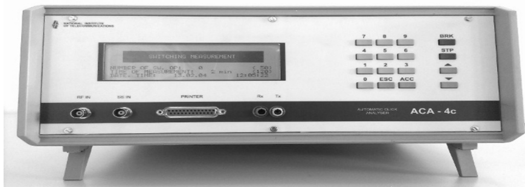
Rys. 4. Widok analizatora zaburzeń krótkotrwałych ACA-4c
