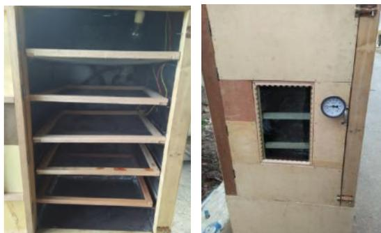
Gambar 7. Alat pengering pinang tipe *tray dryer*
