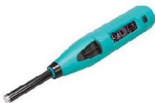
Fig – 3.2.1a) Rebound hammer
