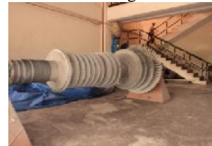
Fig. 4. 32MW Turbine rotor
