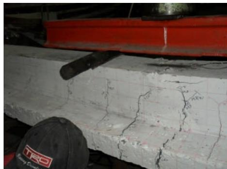
Gambar 11 Pola retak balok perkuatan tipe 1 (BP1).
