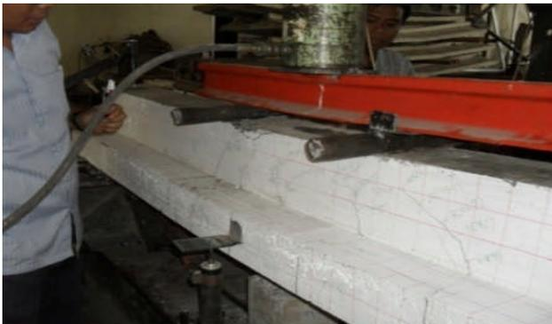
Gambar 12 Pola retak balok perkuatan tipe 2 (BP2).
