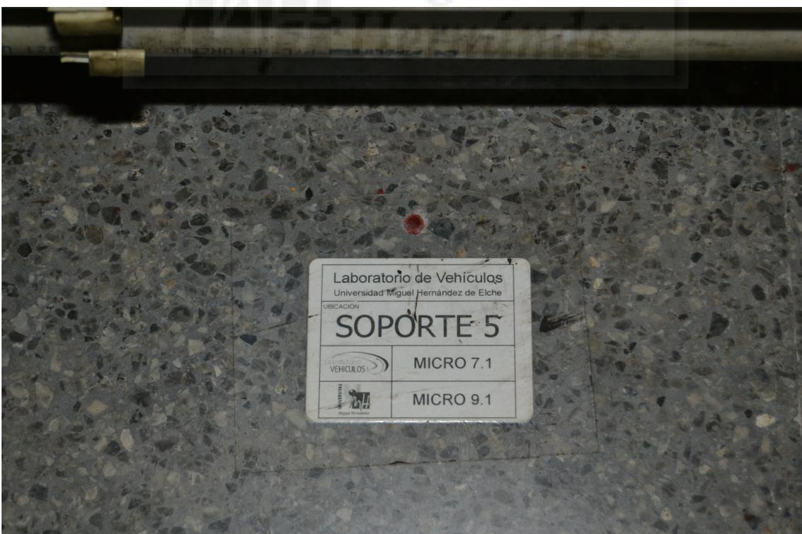
Fig. 48. Marcado de la posición de los soportes mediante agujeros y tacos de plástico rojo
