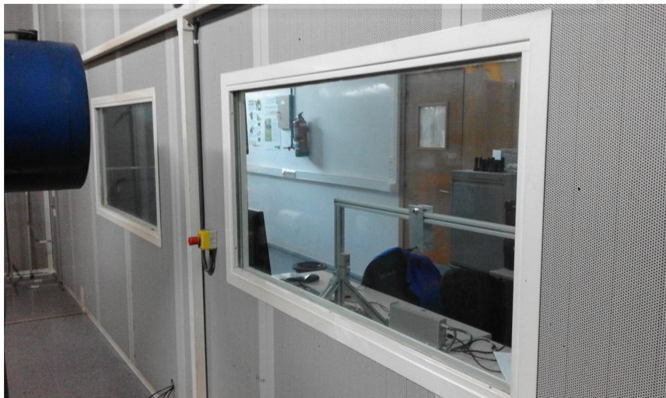
**Fig. 32.** Ventanas para el control visual dispuestas en una de las paredes del cerramiento
