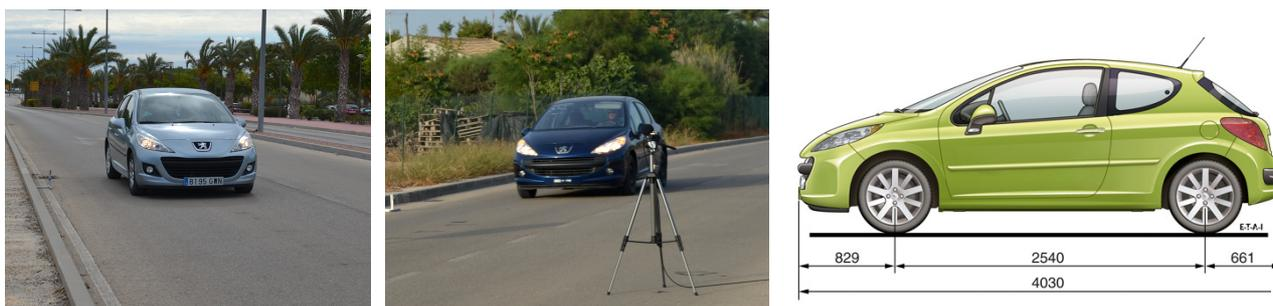
**Fig. 23.** Vehículos utilizados durante los ensayos en pista y sus dimensiones exteriores
