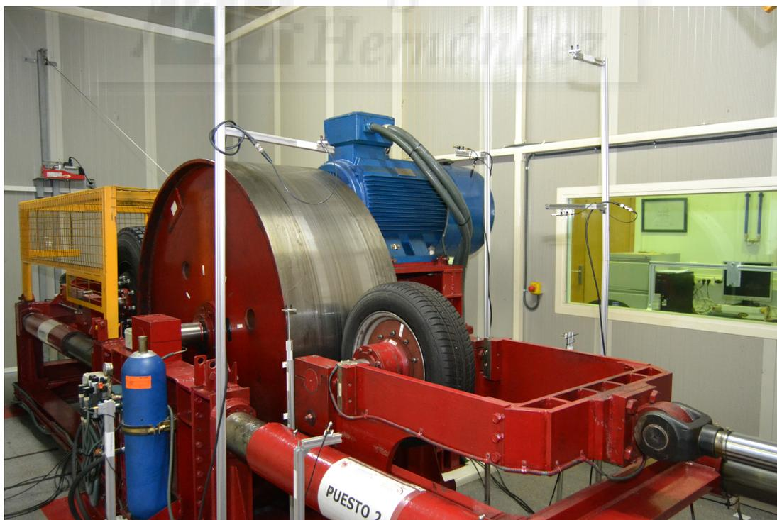
**Fig. 45.** Soportes montados en la sala de ensayos para la superficie de medición de radio 1 m
