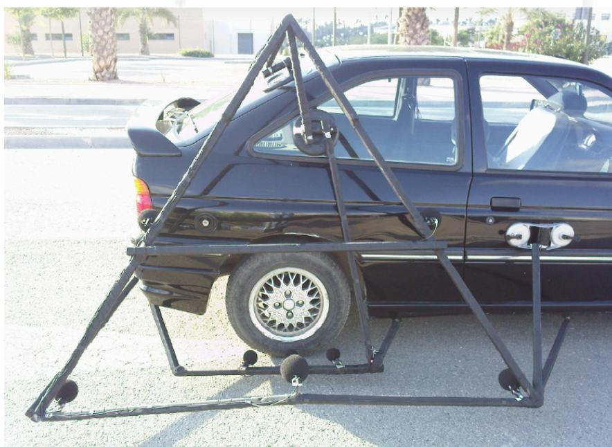
**Fig. 61.** Montaje para ensayo según el método *Alternative CPX* propuesto por Campillo.
