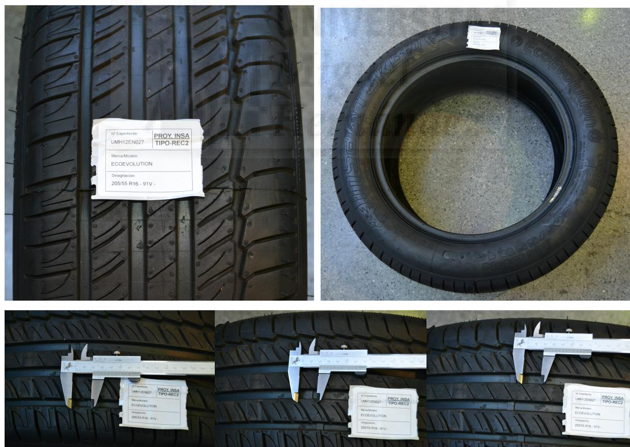
**Figura 53.** Medida de la longitud del taco para el cálculo de la frecuencia característica de impacto
