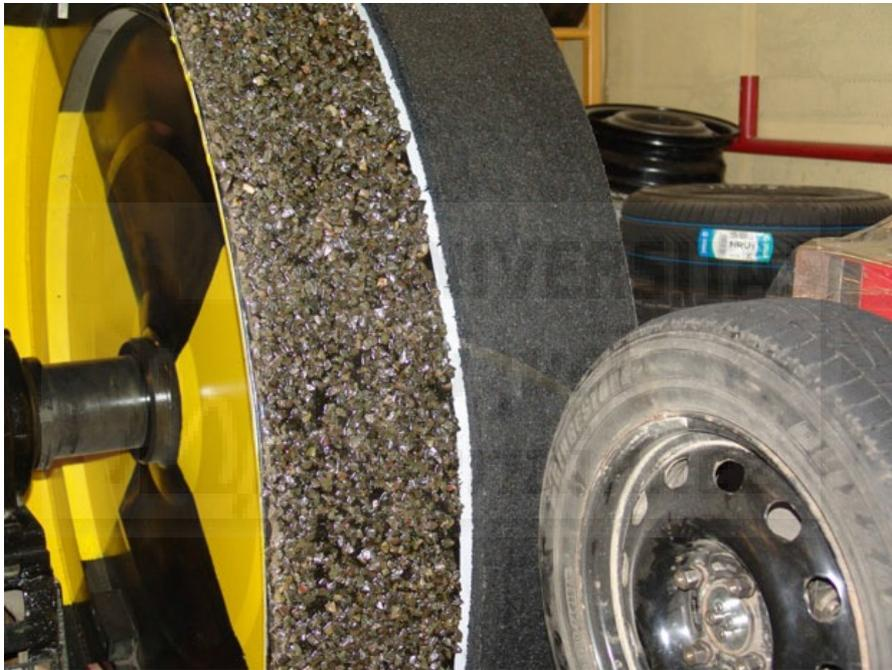
**Fig. 11.** Rodillo cubierto por las diferentes superficies réplicas de asfalto
