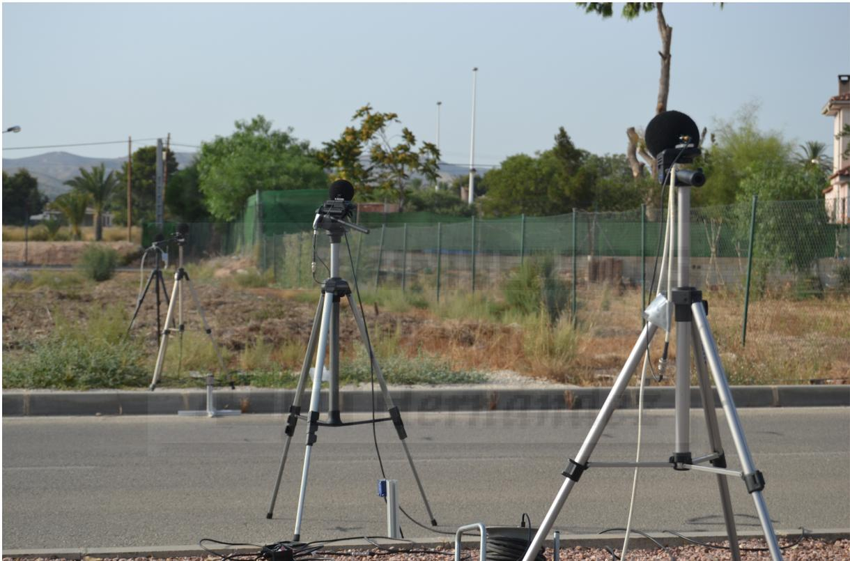
**Fig. 22.** Detalle de colocación de los micrófonos y las fotocélulas para la medición de la velocidad.
