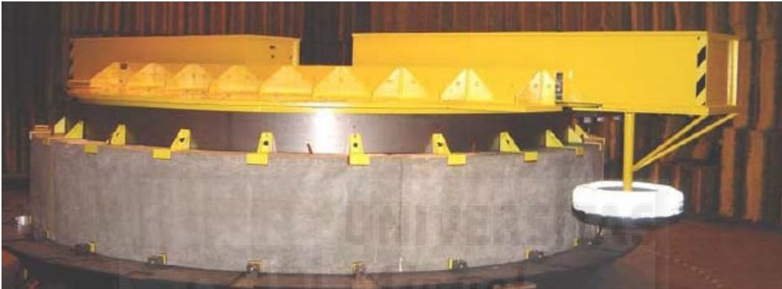
**Fig. 7.** Máquina de ensayos *Tire-Pavement Test Apparatus* de la Universidad de Purdue.
