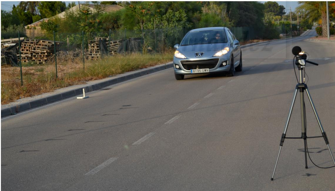
**Fig. 21.** Colocación de los micrófonos en la zona de ensayo.
