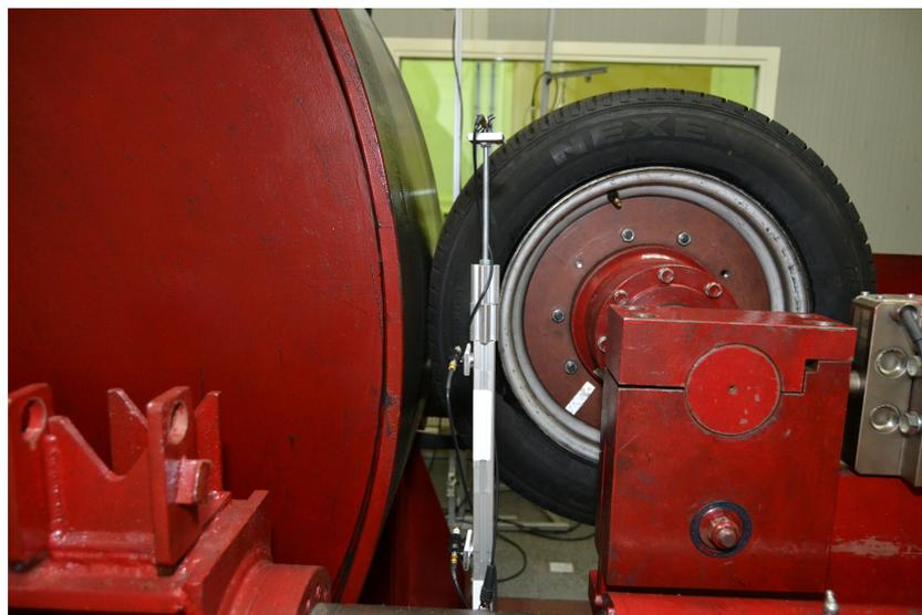
**Fig. 44.** Soporte CPX situado en su posición y con los micrófonos montados.
