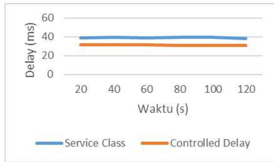
Gambar 4. Grafik Perbandingan Delay antara CoDel dan Service class WiMAX (IP Address 10.1.1.3 -> 10.1.1.1)
