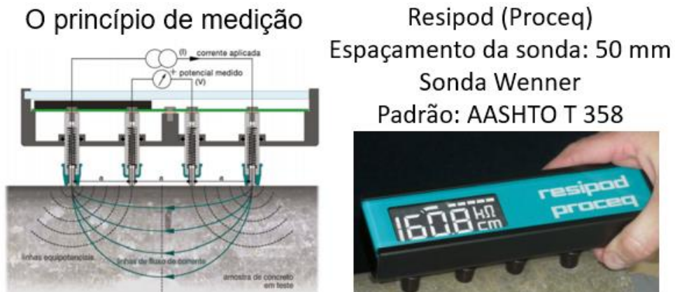
Figura 5 – Aparelho de medição – 4 eletrodos.
