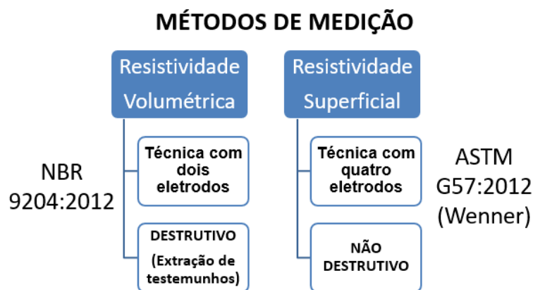
Figura 3: Métodos de medição da resistividade elétrica do concreto utilizados na pesquisa.
