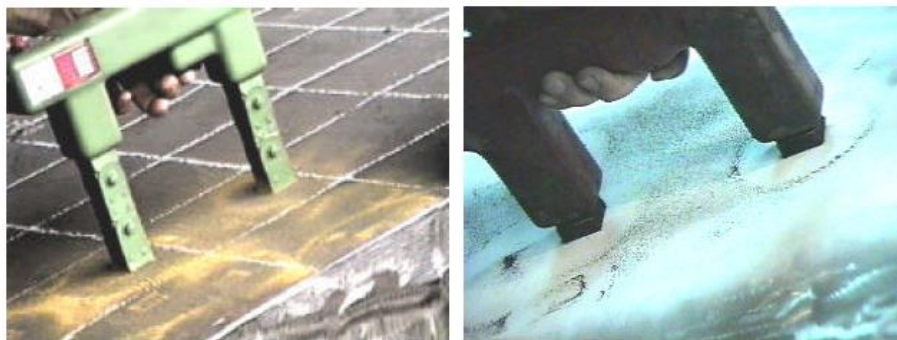
Figura 8 - Magnetização utilizando ferramenta Yoke.
