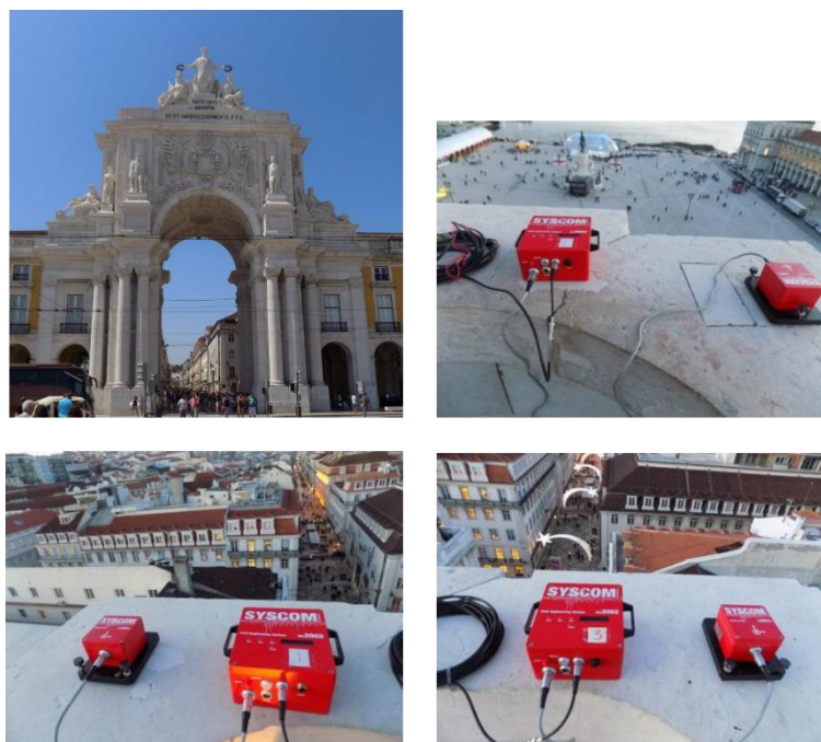
Figura 6 - Teste de vibração ambiental realizado no arco da Rua Augusta em Lisboa. Visão geral do arco e configuração do teste (adaptado de (Carvalho, 2015)).
