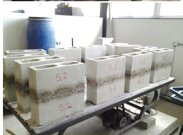
Figura 4 – Confecção dos prismas com a ajuda de um gabarito de limitação de espessura.
