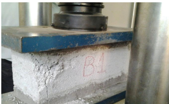
Figura 1 –Ensaio para determinação da resistência dos blocos de concreto.
