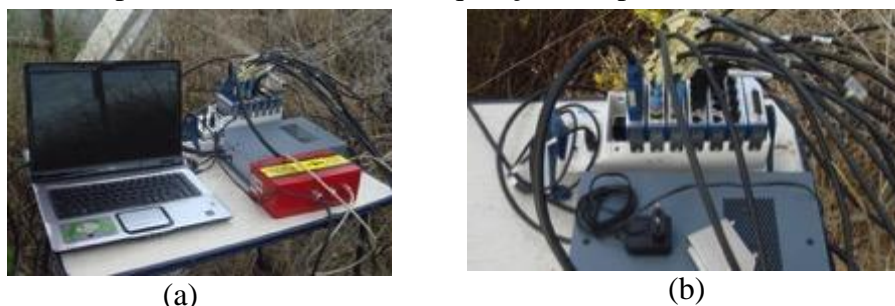
Figura 5: Sistema de aquisição montado no campo experimental: (a) sistema completo e (b) pormenor da unidade de aquisição compacDAQ 9172
