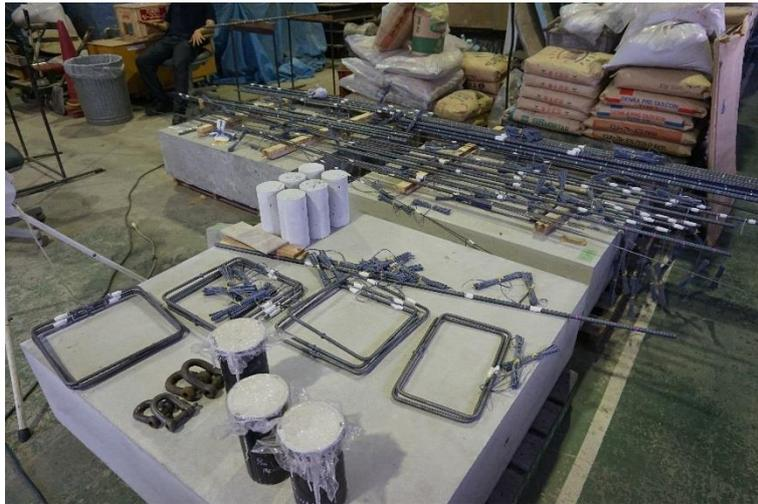
写真 2.1-1 鉄筋ひずみゲージ貼り付け後
