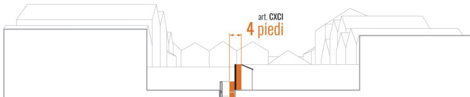
Pozzo e latrina
