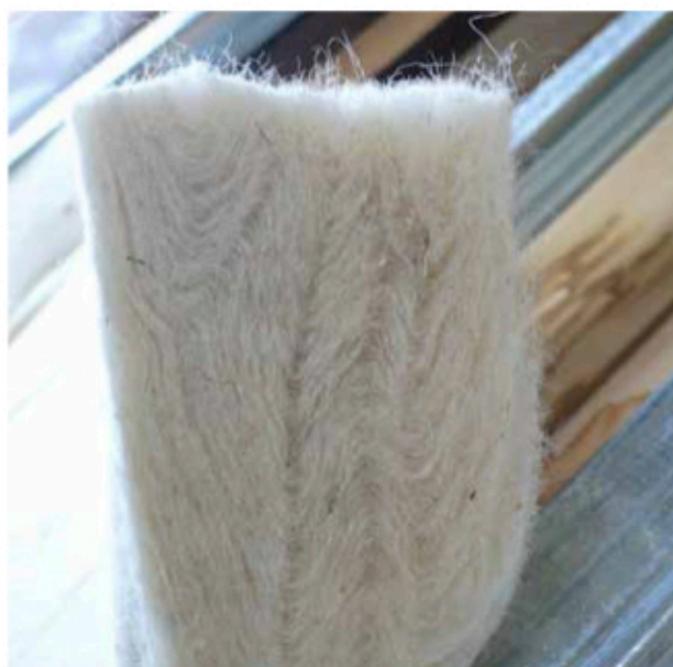
Lana di pecora sambucana della Valle Stura (Ecomuseo della Pastorizia) utilizzata per la coibentazione di alcuni edifici della borgata Paraloup.
