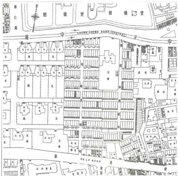
Fig.44. Tipico quartiere formato da abitazioni tipo Shi Ku Men: le strade interne servono solo il quartiere e sfociano in più punti sulle arterie principali. In Wu Jiang, "A History of Shanghai Architecture. 1840-1949", Tongji University press, Shanghai, 1996
