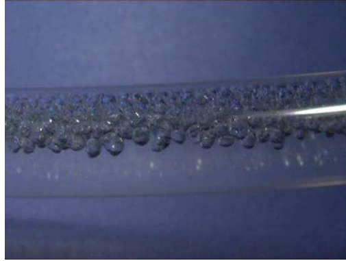
Figura 112: Portata d'acqua 800 l/h e portata d'aria 300 l/h vista verticale, (elica D = 1 m). Circuito A.
