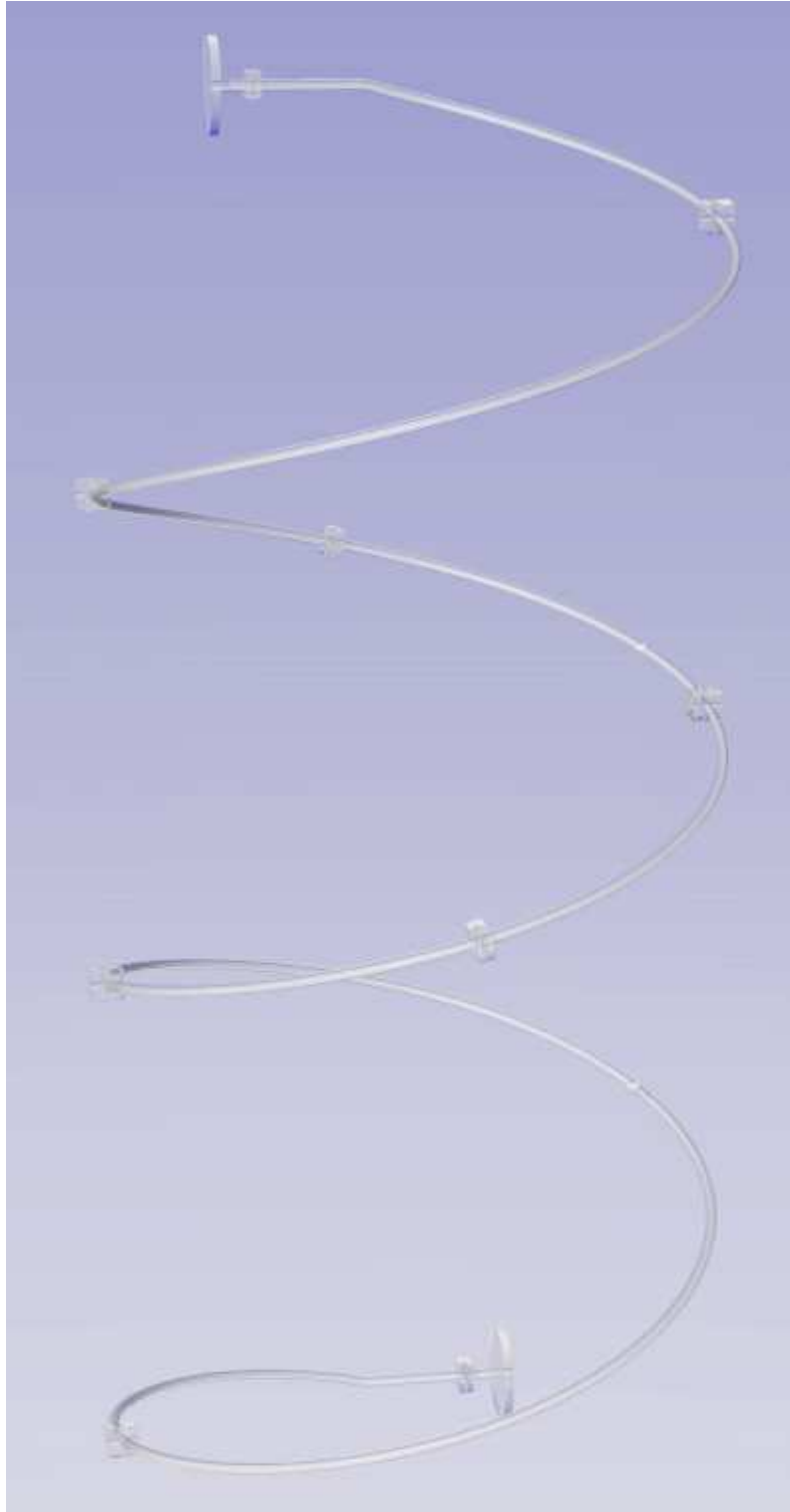
Figura 16: Tubo elicoidale con prese di pressione e flange (rendering).
