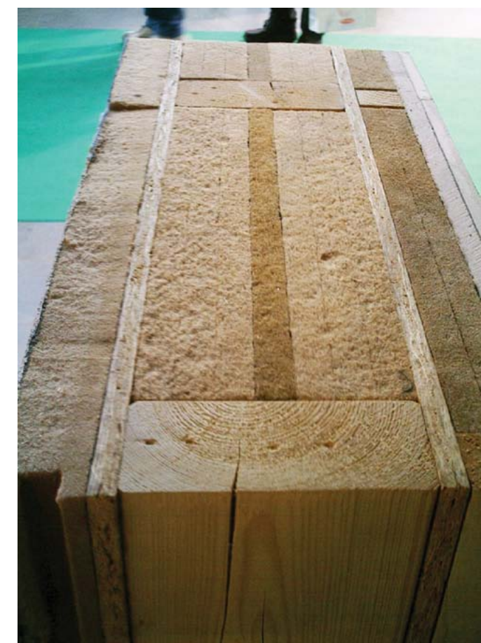
[Fig. 32 - sistemi di involucro con struttura in legno e pannelli isolanti in fibra di legno - fiera Green Building - Verona, maggio 2010 - foto Andrea Bocco]
