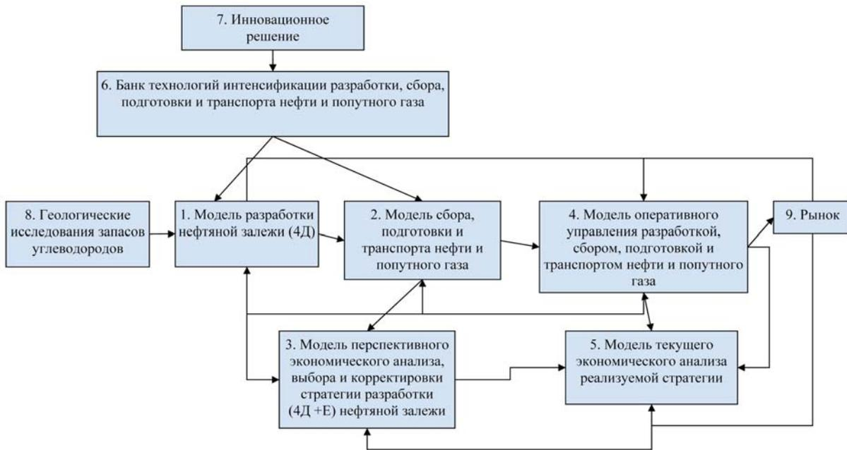
Рис. 1. Блок-схема компьютерной модели управления полным жизненным циклом разработки нефтяной залежи
