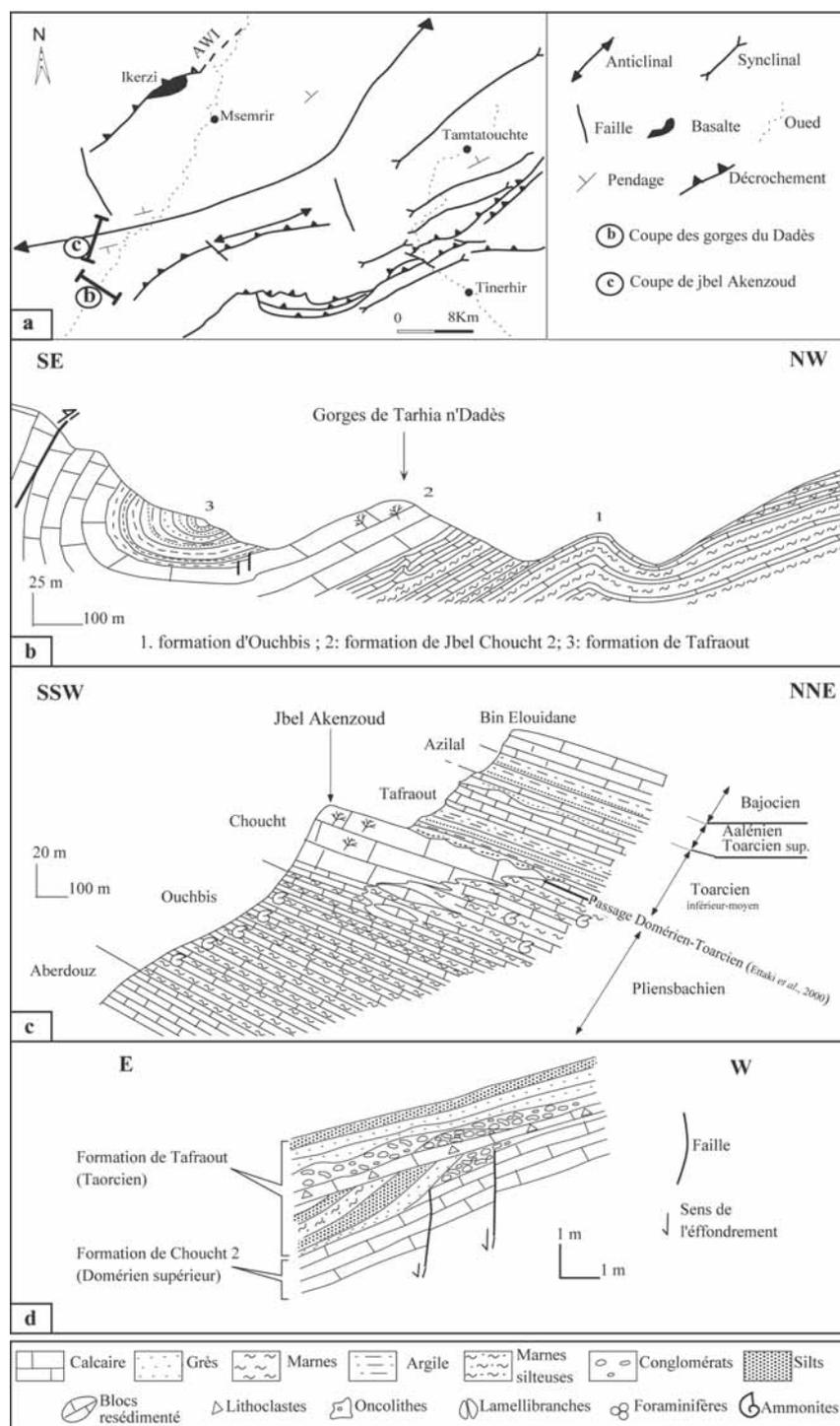
Fig. 4.— Coupes géologiques dans les gorges du Dadès. a : situation des coupes sur la carte structurale du Haut-Atlas de Toudra-Dadès ; b : coupe de Tarhia n'Dadès ; c : coupe de Jbel Akenzoud ; d : schéma représentatif de la limite Domérien - Toarcien à Tarhia-n-Dadès.
