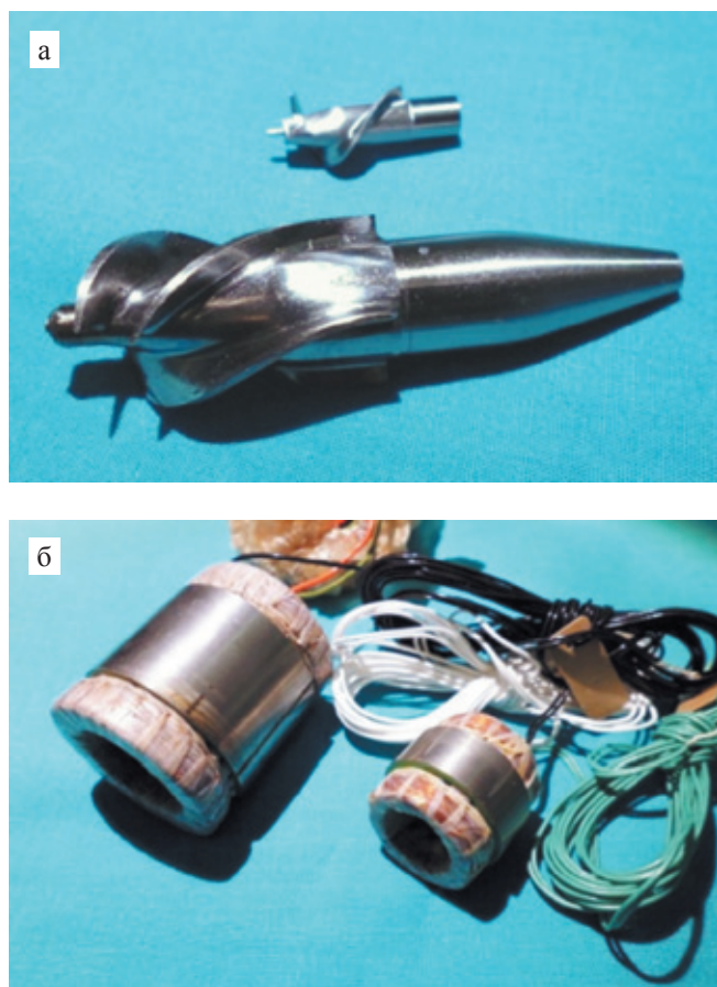
Рис. 9. Узлы экспериментального образца детского ОН в сравнении с узлами взрослого ОН ВИШ-1 (а – РК насос; б – статор бесконтактного двигателя)
