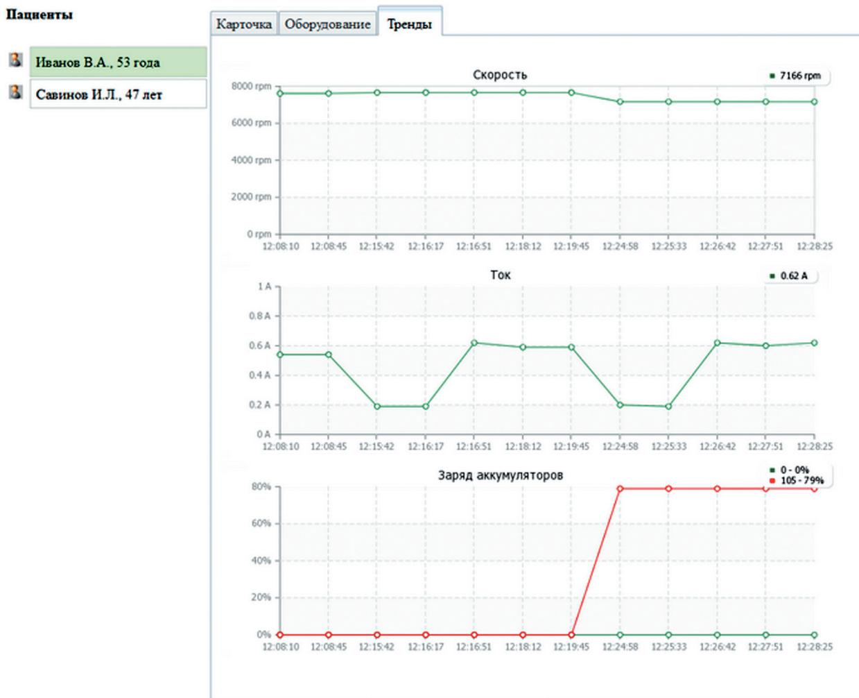
Рис. 4. Экран on-line трендов характеристик оборудования АВК-Н в режиме дистанционного мониторинга (первый канал)
