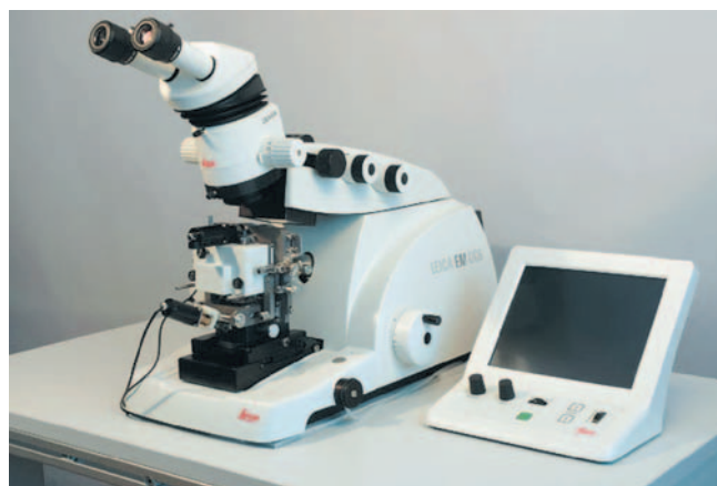
Рис. 1. Экспериментальная установка для сканирующей зондовой нанотографии Ntegra Tomo, комбинирующая ультрамикротом и сканирующий зондовый микроскоп
